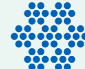
■ Drahtseil mit Stahleinlage (WC)
