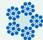
■ Drahtseil mit Fasereinlage (FC)
