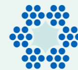
■ Drahtseil mit Fasereinlage (FC)
