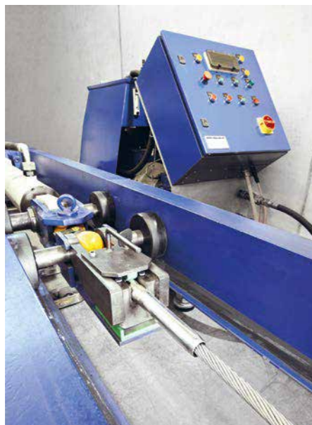
Kontrolliertes Ablängen und Vorrecken Découpes et pré-étirements contrôlés Controlled cutting to length and pre-stretching
